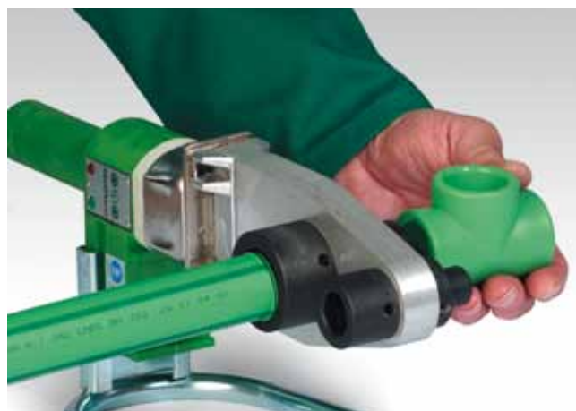
Anwärmen der Formteile
