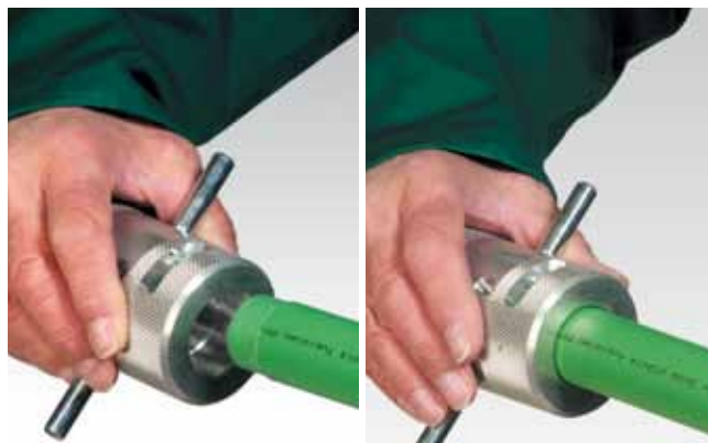
Segno della profondità di fusione.
