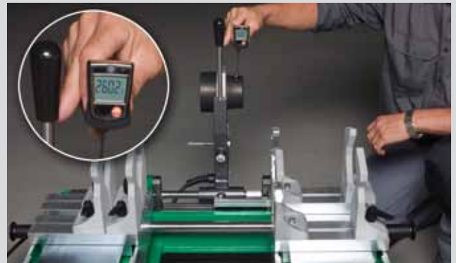
Temperaturmessung an der aquatherm- Schweißmaschine
