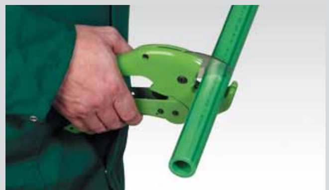
Abschneiden des Rohres
